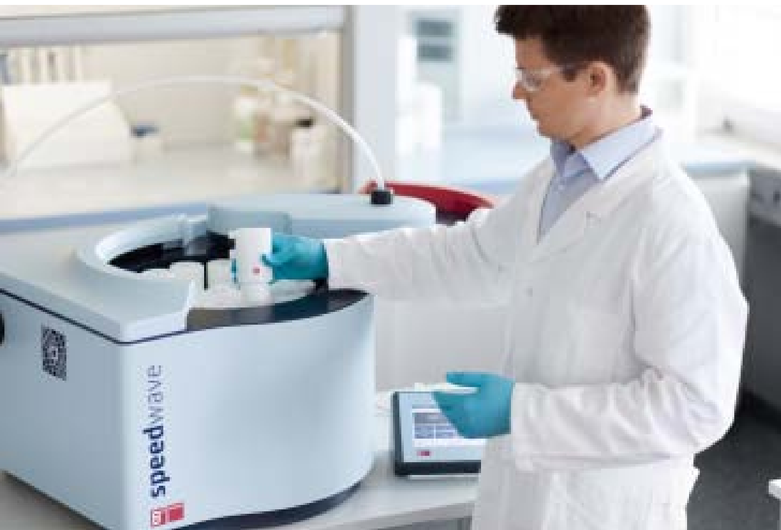
Bild 2: Die Speedwave XPERT eignet sich auf Grund ihres runden Ofenraums und abgedichteter Gefäße ideal für die Probenvorbereitung zur Schwermetallanalyse in Arzneimitteln. © Berghof
